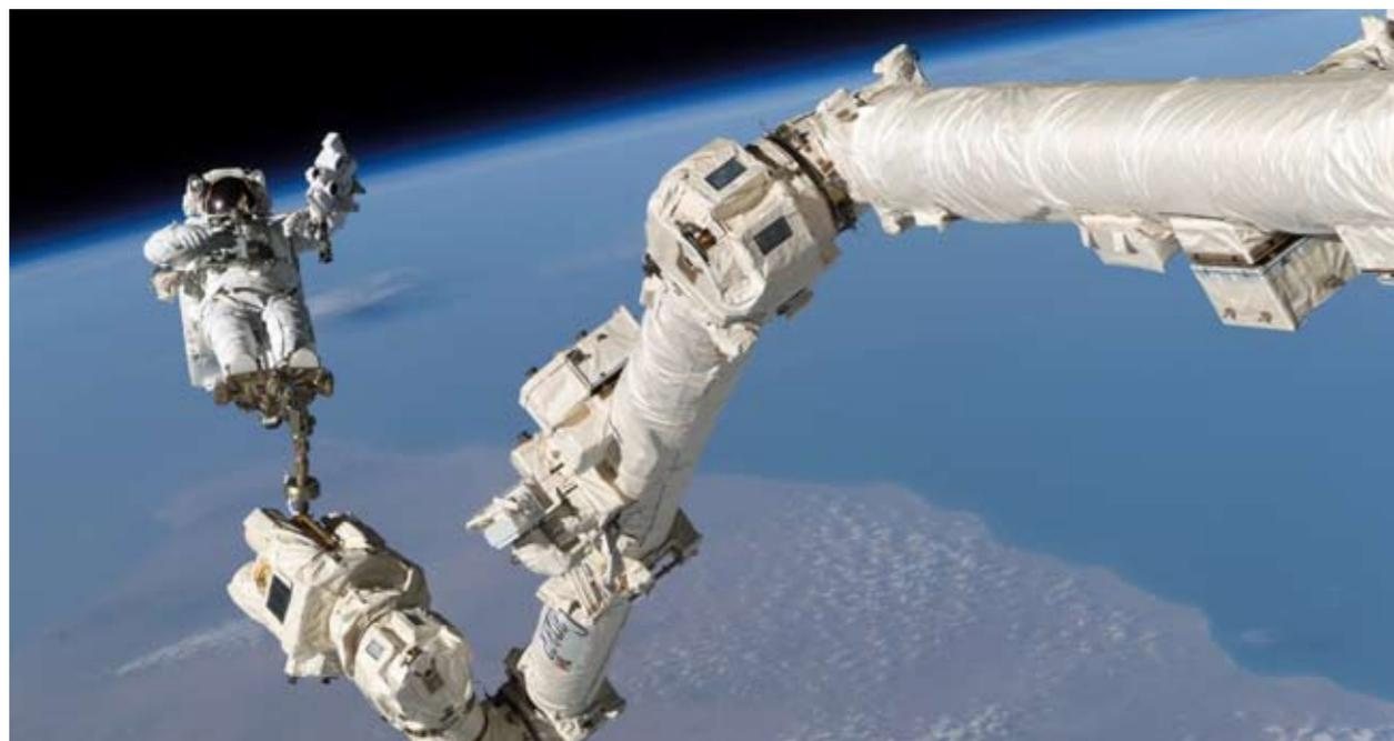
*Lo Space Station Remote Manipulator System (SSRMS), utilizzato fin dal 2001, è il più noto tra i manipolatori robotici operanti sulla International Space Station, in grado di trasportare grandi masse e posizionare accuratamente gli astronauti addetti alle operazioni di manutenzione (Foto: NASA/CSA)*
